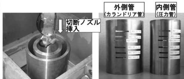
二重管と切断ノズル (二重管内側から切断)
