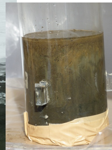
柱状堆積物試料の採取 (重錘型柱状採泥器)
