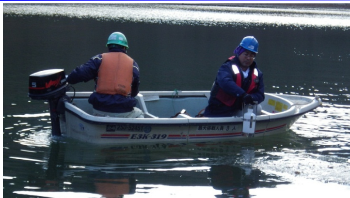
水試料の採取 (船上からハイロート採水器)
