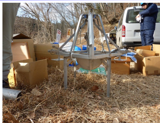
湖底堆積物試料の採取 (スミス・マッキンタイヤ採泥器)
