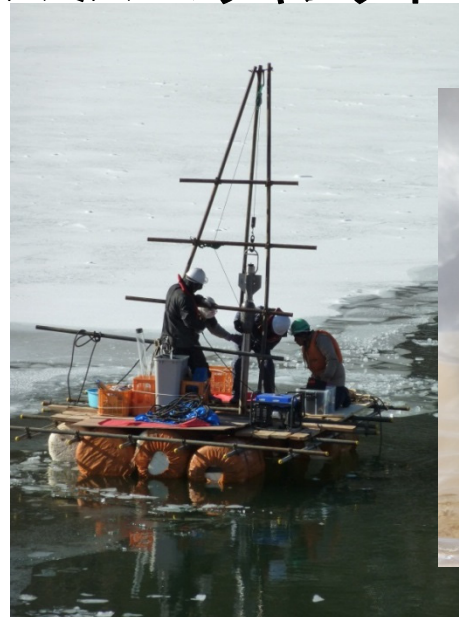
柱状堆積物試料の採取 (重錘型柱状採泥器)
