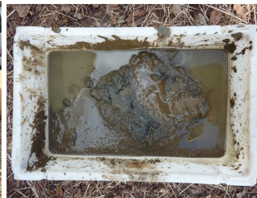
湖底堆積物試料の採取 (スミス・マッキンタイヤ採泥器)
