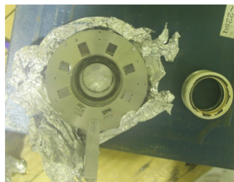
破損したCT(電流器)
