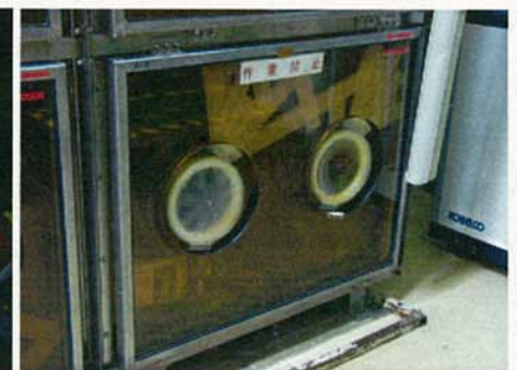
補修後 (テープ固定)
