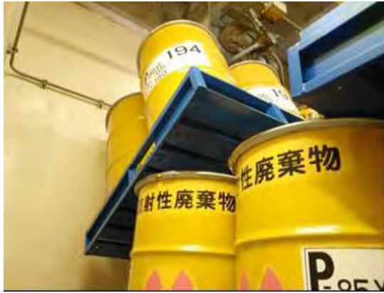
保管体の荷崩れ
