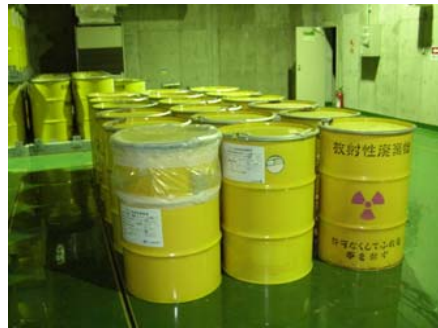
落下、荷崩れし、取出したドラム缶を平置で保管
