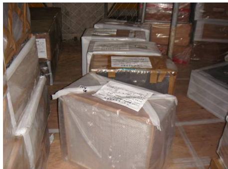
フィルタ梱包物の荷崩れ(梱包の破れ無し)
