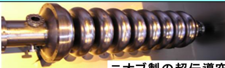
ニオブ製の超伝導空洞
