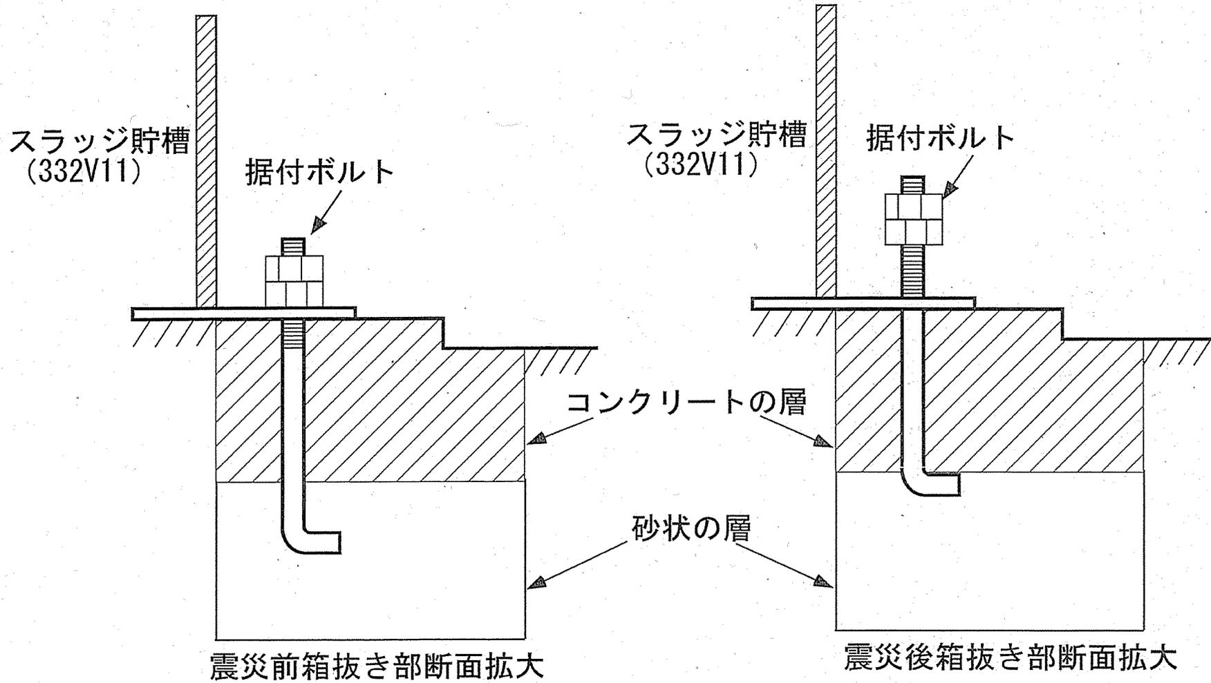
図-3 東日本大震災前後の箱抜き部の据付ボルト
