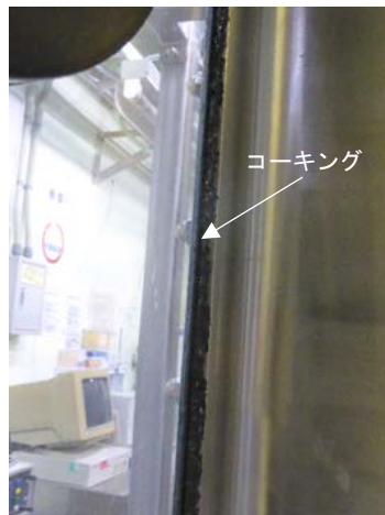
[コーキングの例2] グローブボックス内側への コーキング
