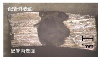
腐食孔の断面部
