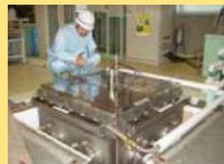
熱-水-応力-化学連成試験
