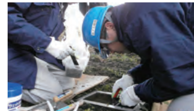
●スクレーパープレート スクレーパープレートを用いた土壌採取では、センチメートル単位で土壌を採取し、放射性セシウムの濃度と土壌の特性を知ることができる。
