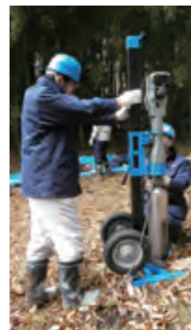
●土壌サンプラー 土中に円筒を押し込んだ後、それを引き上げることで、円筒内に押し込まれた土を層構造を乱さず円柱形のままで掘り出すことができます。
