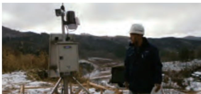
●気象観測一体型放射線モニタ 上部についたカメラが正面のようすを画像でとらえ、雨量計や風速計などが気象データを観測する。さらに放射線センサが空間線量率を測る。これによって気象条件の変化と空間線量率の変化を、同時に観測することができる。
