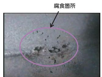
焼却処理工程の洗浄塔（SUS304L）
