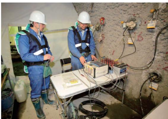
調査は同じ断面での計測を繰り返す。坑道を先に掘り進めていくにつれ、その周囲の岩盤中の弾性波の変化がデータとして取得される。
