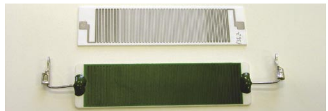
従来の抵抗器(上)と開発された新型の抵抗器(下) 円筒型を平型にして電気経路を蛇腹に通した。
