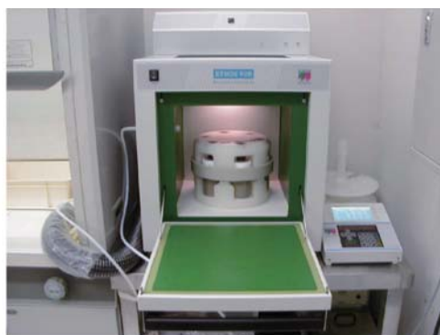
マイクロ波加熱装置 食品の加熱に使用される電子レンジと同じ仕組みです。容器に入れた酸と試料を内部から加熱することができます。
