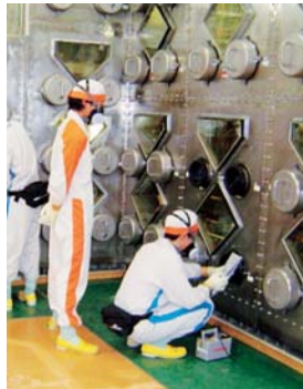
グローブボックス作業前の点検作業
