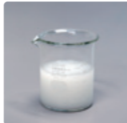
プラスのポリイオンの水溶液とマイナスのポリイオンの水溶液を混ぜ合わせるとポリイオンコンプレックス(PIC)と呼ばれるゲル(ジェル)状の物質が生成する
