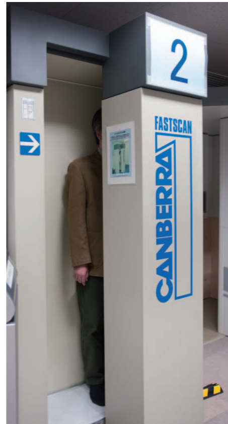
▲(写真1)ホールボディカウンタ(立位式:装置内です立ったまま測定するタイプ)福島で多く使用されたのがこのタイプ
