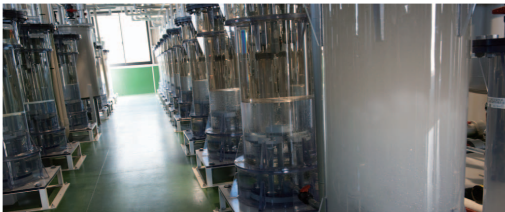
▲福島県いわき市に建設されたエマルションフロー法の装置(手前の装置は乳濁状態になっており、エマルションが発生している)
