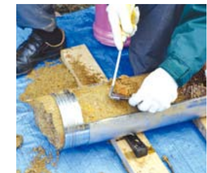
土壌サンプラーを用いた土壌採取の様相
