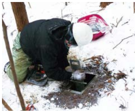
スクレーパープレートを用いた土壌採取の様相
