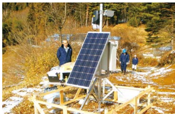
気象観測一体型放射線センサー。 原子力機構と福井市の山田技研(株)が共同研究で開発。
