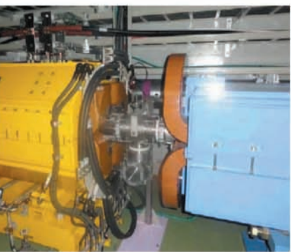
●J-PARC 50GeVシンクロトロン 目視ではほぼ健全だが、詳細な点検を実施
