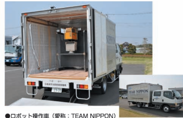
●ロボット操作車（愛称：TEAM NIPPON） 放射線計測やロボット操作を迅速かつ安全に行えるよう、トラック（バン）に鉄板80mm遮へいオベレーションBOX（ガンマカメラ、監視カメラ、照明等を装備）、発電機等を装備したものです。
