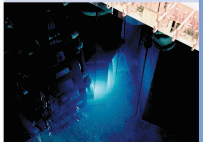
●JRR-4の炉心部分で青白く輝く光は「チェレンコフ光」と呼ばれているもので、原子炉の出力が高いときに見ることができます。
