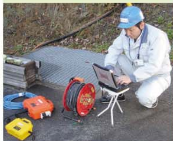
●地上で受振するために測定器を準備している様子。
