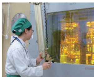
▲マニプレータを用いたセル試験
