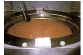
ウラン・プルトニウム混合酸化物 (マイクロ波加熱脱硝法)
