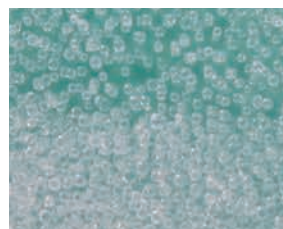
◀開発した吸着材 (平均粒径0.21-0.50mm)
