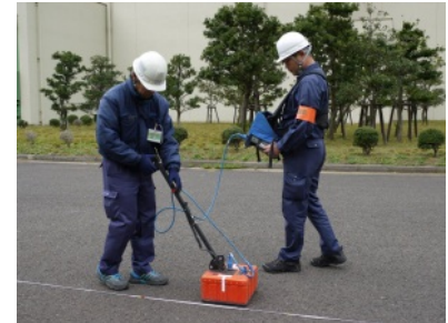
【破砕帯追加調査 (地中レーダー探査)】 (撮影日 平成24年11月13日)
