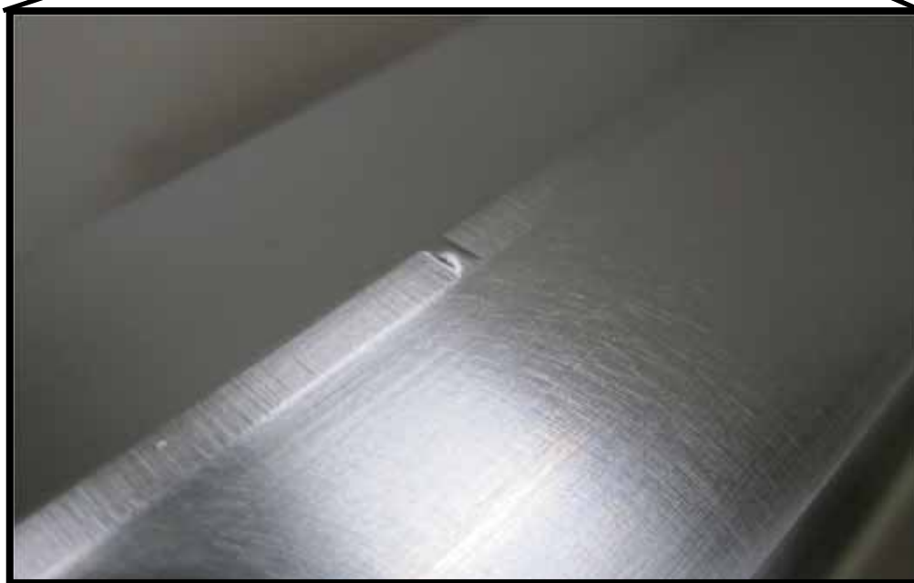
試験後外観写真(試験条件No.1:押付け荷重700kN)
