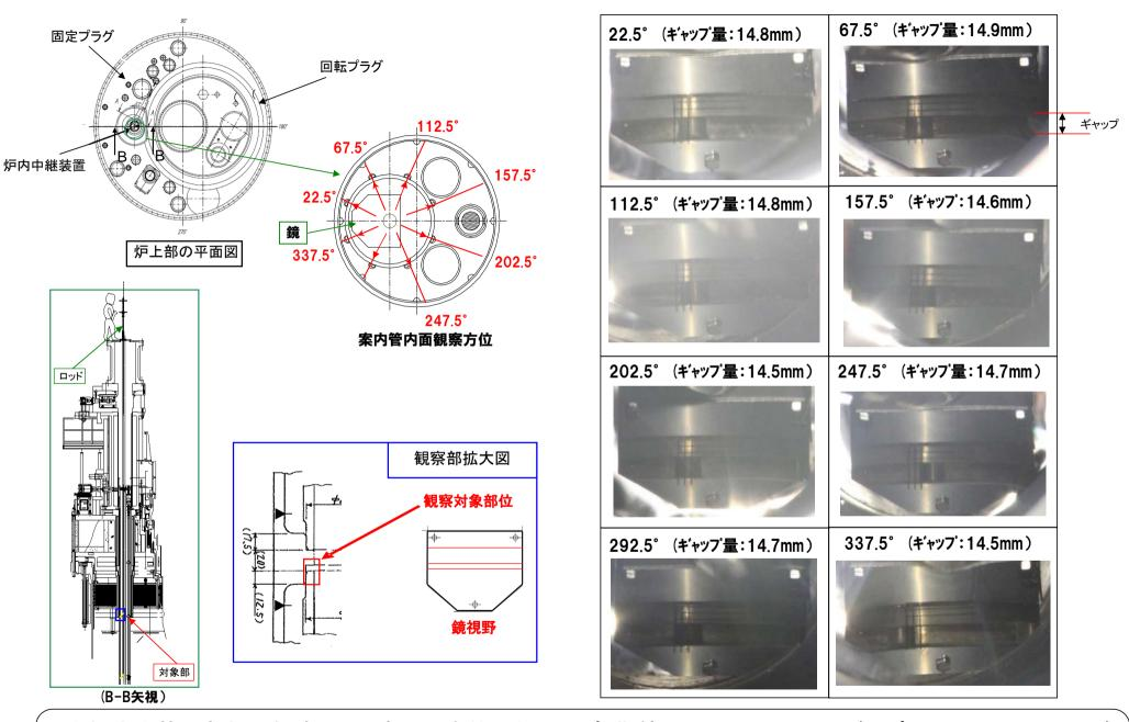
内側案内管上部側の観察では、全ての方位において、初期値(5~7mm)以上のギャップ(14.5~14.9mm)が確認されました。計測値は最大で0.4mmの差がありましたが、隙間の大きいところが一定の方位に集中していないことから、計測誤差によるものと判断しています。
