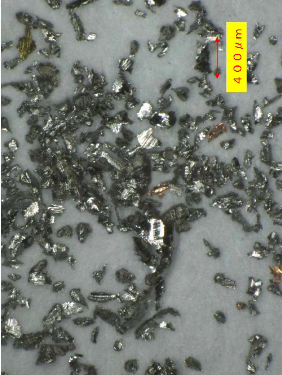
図-11 (1/3) 検出器C 内壁調査 SUS管底部捕集物 マイクロスコープ結果
