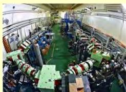
エネルギー回収型超電導リニャック自由電子レーザー
