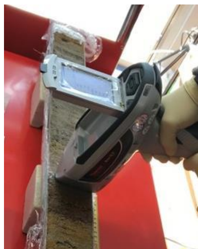
携帯型X線分析装置 による堆積物表面の 元素分析
