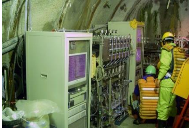
図 2-2 ボーリング孔に設置した観測装置による長期モニタリングの例
