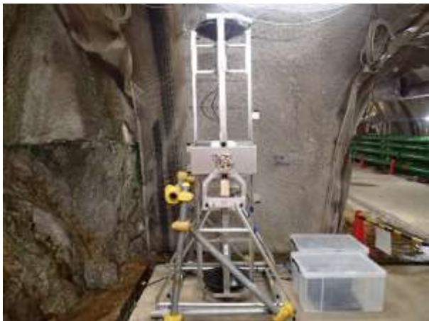
ミュオン粒子を利用した地質構造探査手法の開発に関する研究 川崎地質株式会社との共同研究 (深度300m研究アクセス坑道 100m計測横坑)
