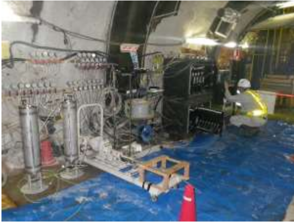
岩盤中の物質の移動に関するボーリング孔 電力中央研究所との共同研究 (深度300mボーリング横坑(換気立坑))
