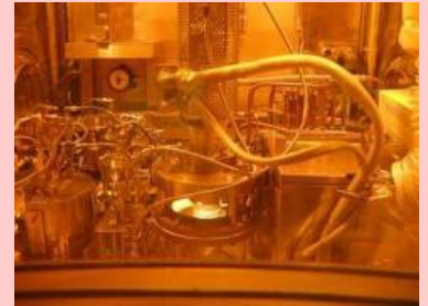
セル内加熱装置 (核分裂生成物放出挙動試験のための照射済燃料加熱装置)
