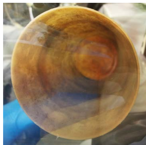
内容物回収後の容器内面の状態 （8月3日撮影）
