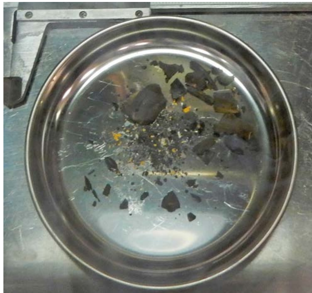
養生シート上から回収・集約した飛散物 (8月2日撮影)
