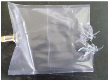
袋の生地部分で破裂した例(ガス注入)
