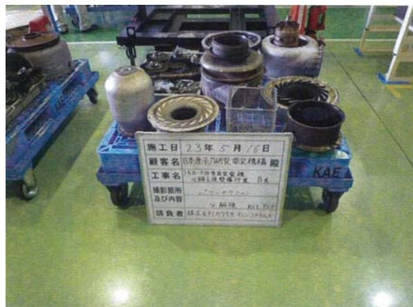
写真 2. 11. 1-2 パワーセクション分解点検後
