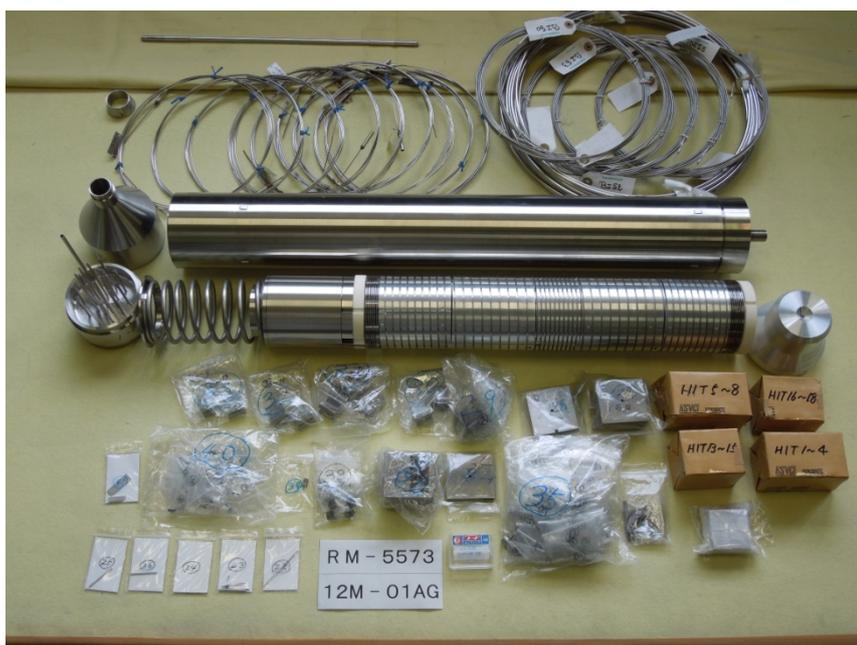
写真 2.3.1-2 破壊靱性評価キャプセル組立前部品
