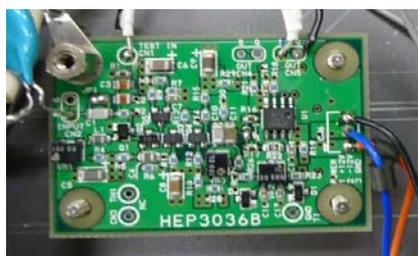
写真 4.2.2-1 試作した前置増幅器
