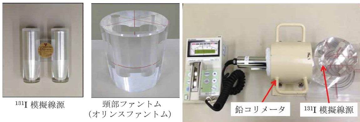
写真 2.8.1-1 校正に用いた線源, ファントム及び校正の様子
