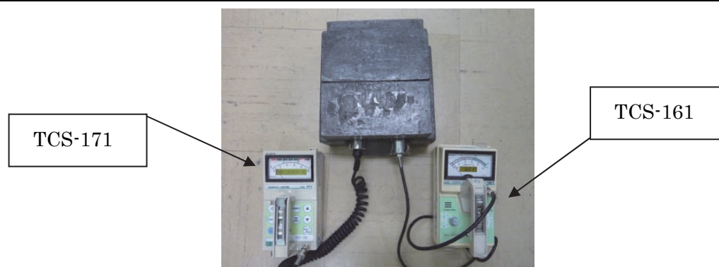
図 2.6.3-1 NaI(Tl)シンチレーション式サーベイメータによる宇宙線感度の測定方法
