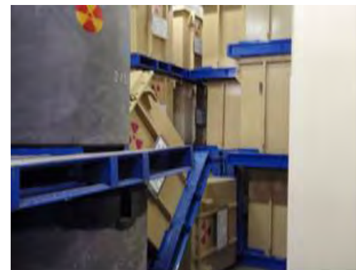
保管体の荷崩れ（未復旧）
