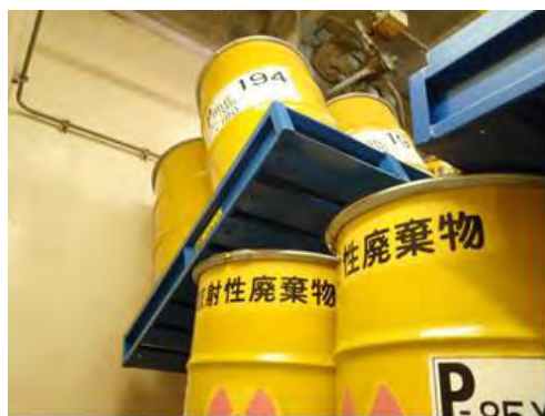
保管体の荷崩れ（復旧前）
