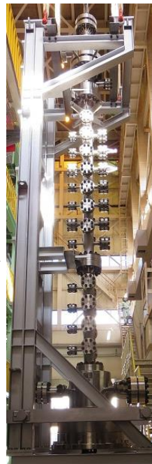
高圧 熱流動 ループ (HIDRA) の熱伝達 試験部
