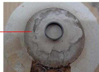
ヒータ付き試料台 (セメントで固定)
