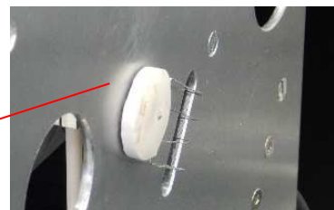
ヒータ付き試料台 (セメントで固定)
