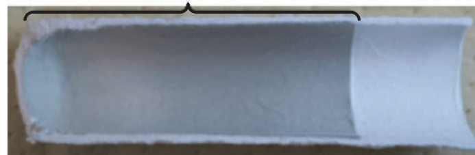
試験後(空気+水蒸気)のガラスフィルタ
