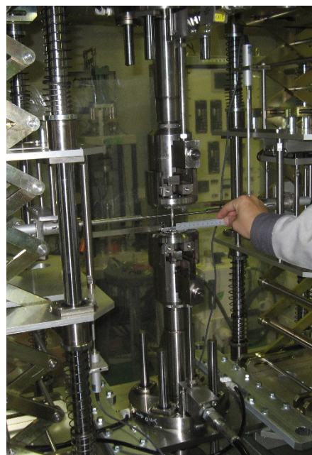
二軸荷重負荷試験装置
