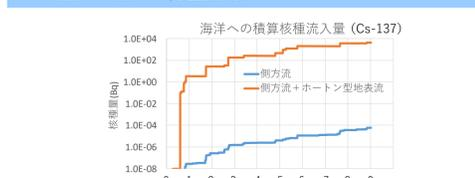
地表面流による海洋への核種移行量評価結果
