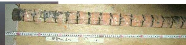
切断後の汚染配管の例
