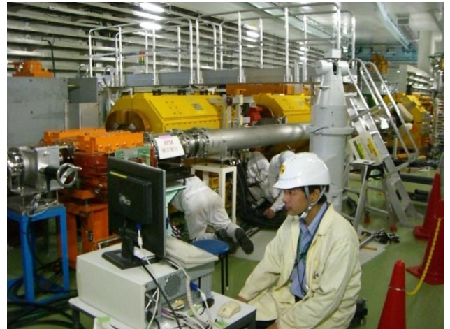
↑ 加速器の精密な位置合わせ(アライメント)作業。レーザー光線を利用した計測器 で、1mm以下の精度で位置を合わせる。(左:リニアック、右:50GeVシンクロトン)
