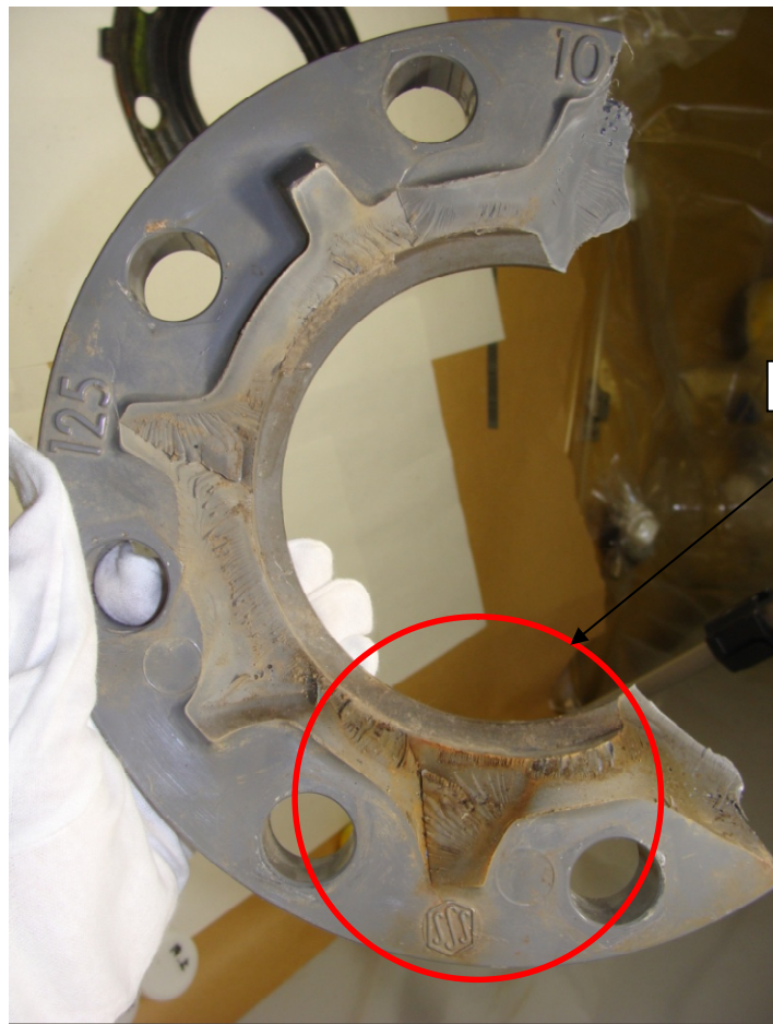
図22 フランジ切断後に観察された内面及びき裂面の状態
