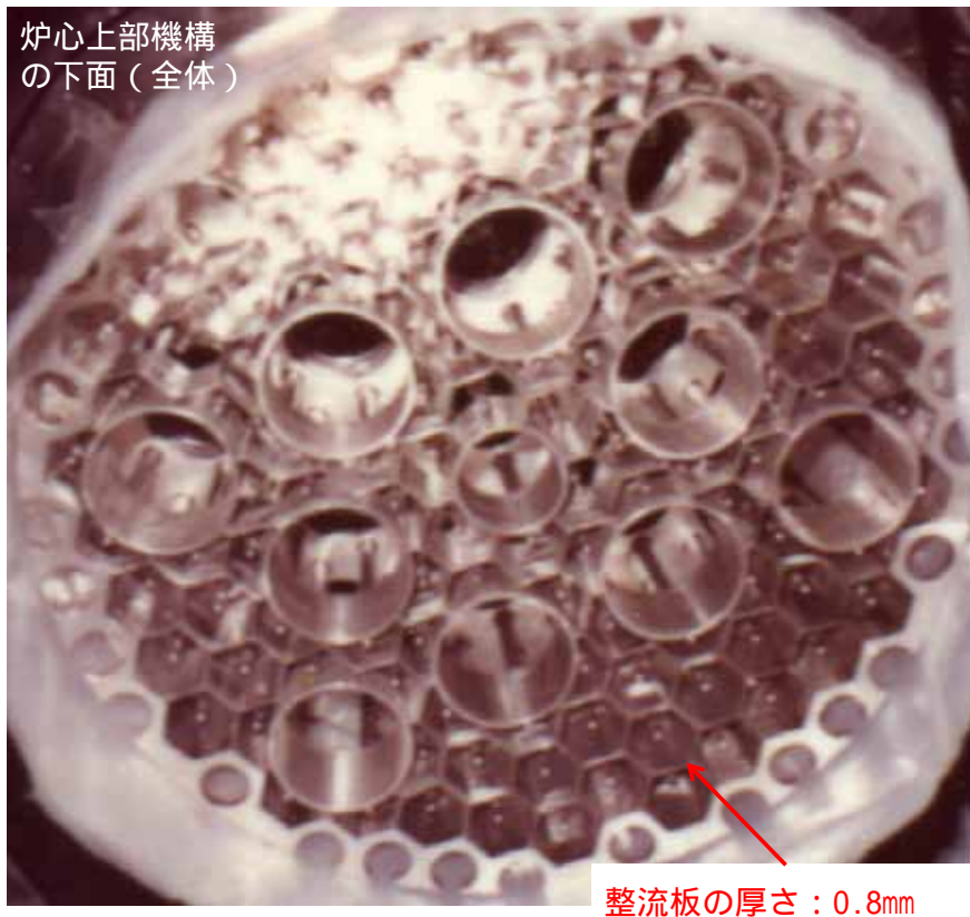
図 4-1 炉心上部機構の外観（建設時に撮影）
