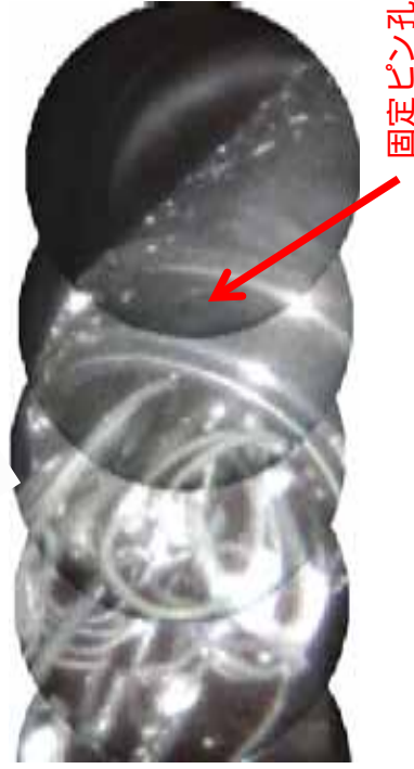
ハンドリングヘッド継手固定ピン孔の状況
