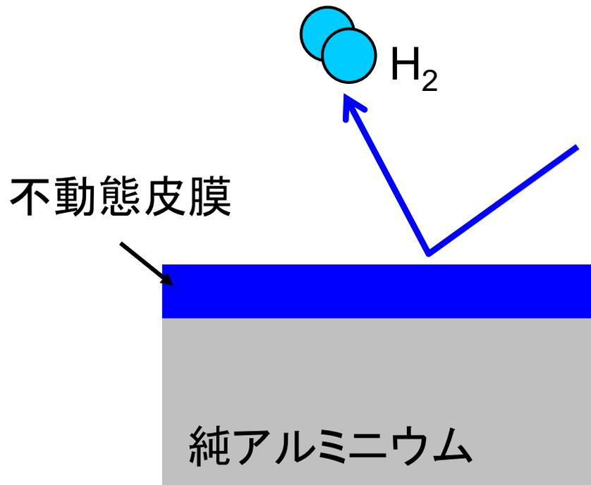
不動態皮膜(うすいアルミニウムの酸化膜)がアルミニウムを水素化から守っている
