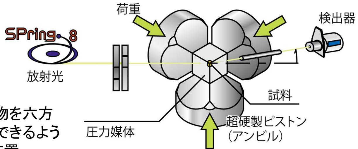
立方体の試料の入れ物を六方向から押し込むことができるように作られた高圧発生装置
