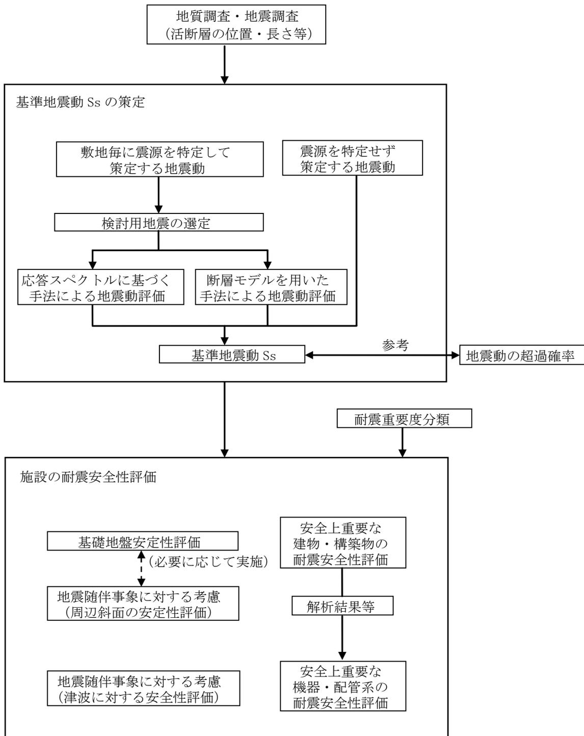
図1 耐震安全性評価 全体計画フロー
