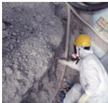
4号機周辺の瓦礫試料の採取
